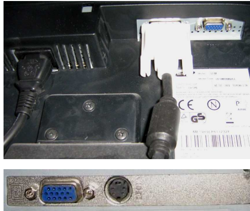
חיבורי מסך (למעלה) וכרטיס מסך שתומך בחיבור אנלוגי (למטה)
